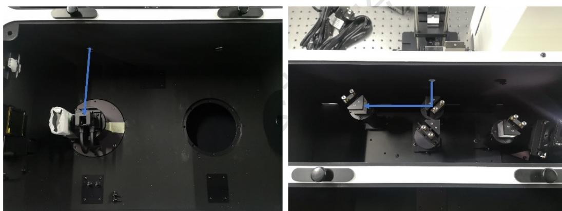
图 7.10. 荧光支架的放置方法和光路走向。
