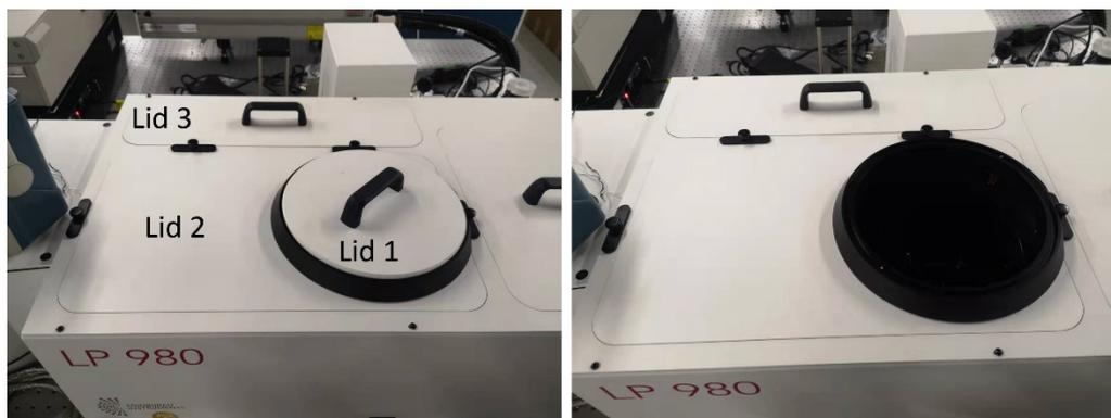
图 7.5. LP980 纳秒瞬态吸收光谱仪主机样品仓部分。
