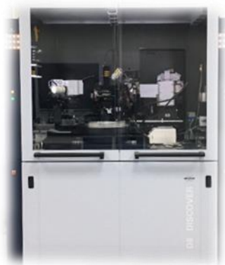
图6-1 Bruker D8 Discover薄膜X射线衍射仪系统
