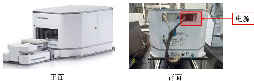
图 6-3-5 自动离心机仪器及电源位置图示
