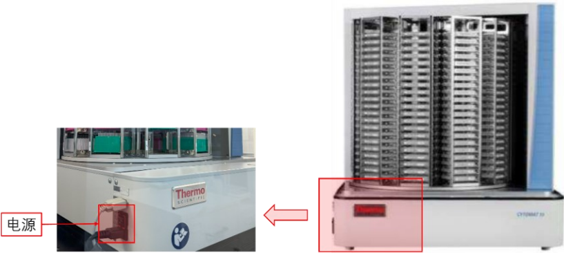
图 6-3-2 高通量耗材储栈电源位置图示
