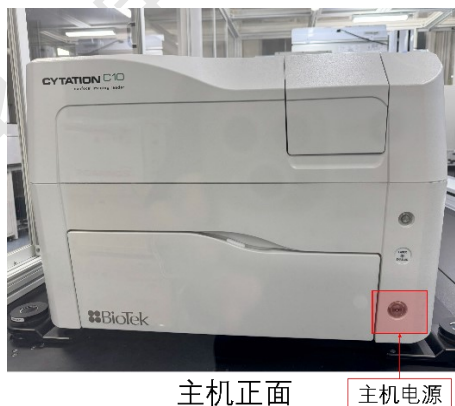
图 6-3-6 高通量细胞成像系统电源位置图示
