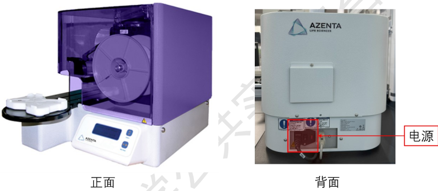
图 6-3-3 自动撕膜机电源位置图示
