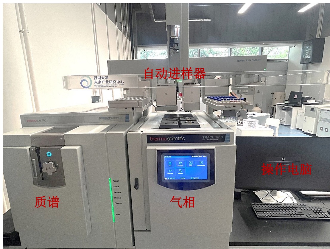
图6-2 仪器硬件组成
