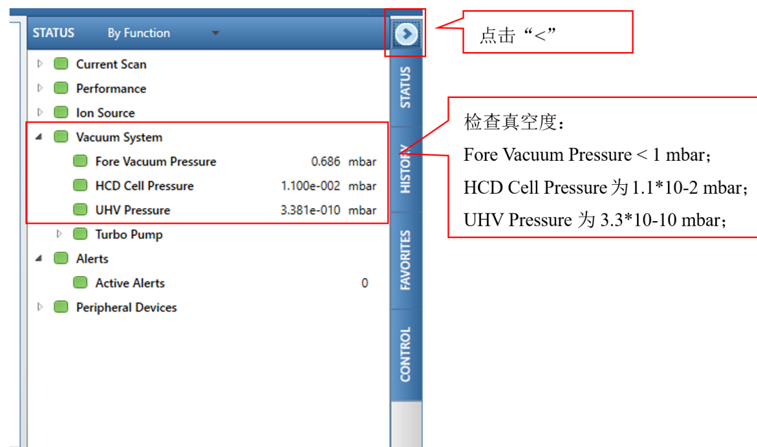
图6-6 质谱真空度检查界面
