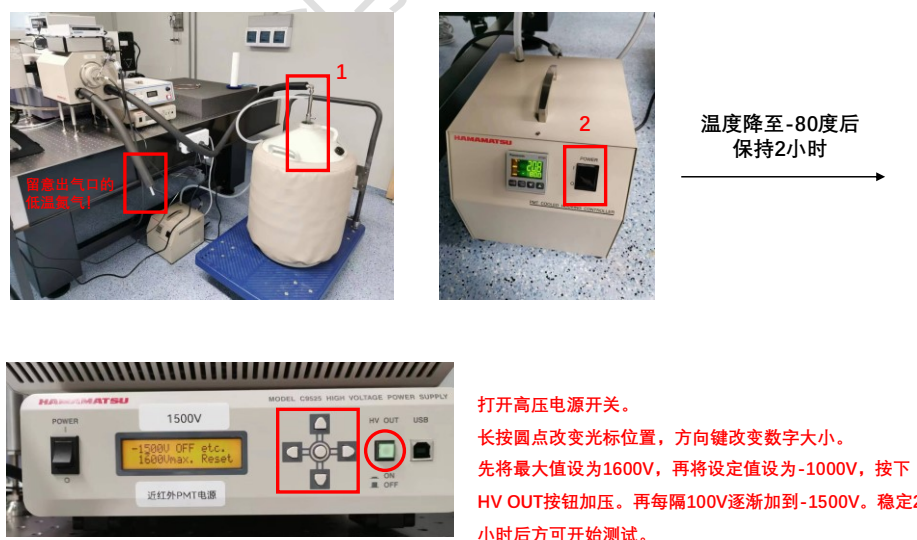
图 7.7. 滨松 R5509 检测器开启方法
