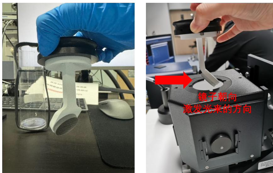
图 7.30. 粉末样品 PLQY 测试中使用的反射镜及摆放方向
