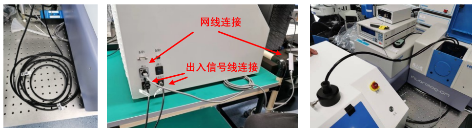
图 7.33. 微孔板附件与光谱仪主机、控制电脑之间的信号、通讯线连接（左、中图）和光路连接（右图）
