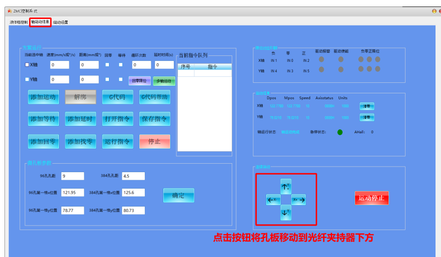
图 7.38. 微孔板附件控制软件中手动控制微孔板运动方向和位置的按钮位置
