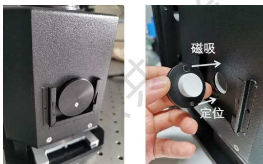
图 7.28 积分球侧面的塞子、滤光片架以及盖子的取放方式
