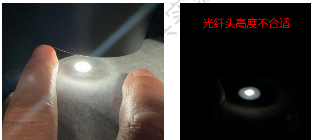
图 7.40. (左) 光纤头高度合适时光斑在孔板上的光斑图形; (右) 光纤头高度过高时, 可在孔板上观察到明显的光斑和外部的光晕, 此时还需调整光纤头高度
