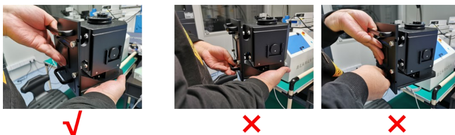
图 7.26. 积分球附件取放时的正确操作和错误操作
