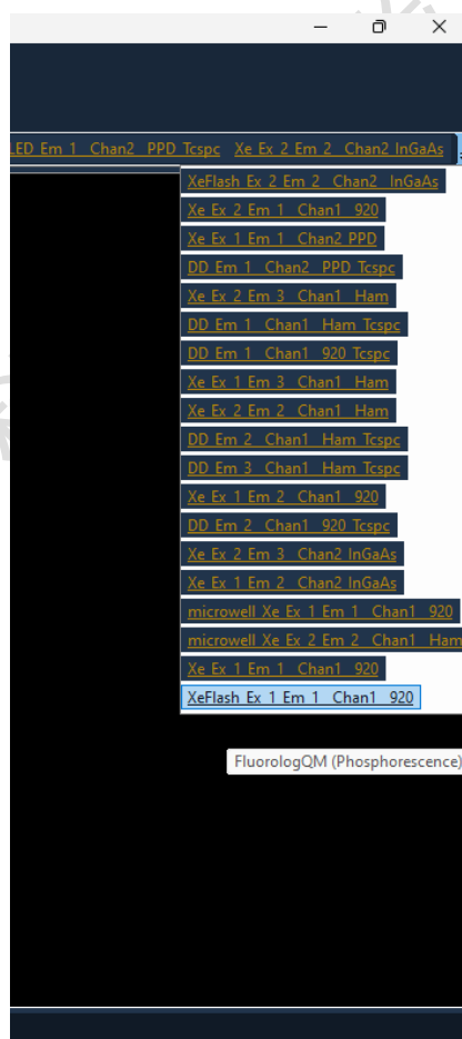
图 7.14. 使用闪烁氙灯作为光源测试磷光光谱时选择的测试模式 (以 1 号单色仪、1 号光栅、R13456 探测器为例)
