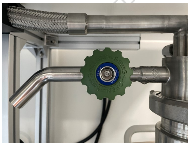
图 7-2 液氮罐排放阀顺时针关闭，逆时针打开
