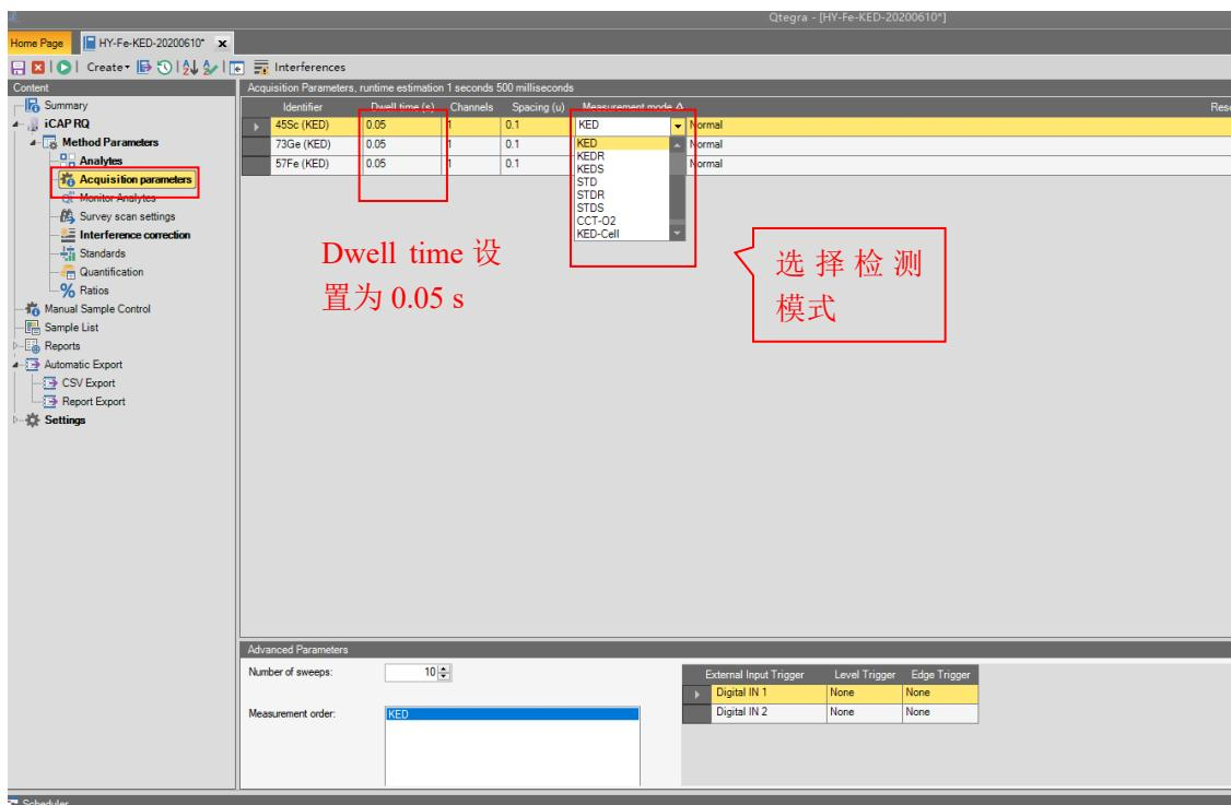
图6-7 Acquisition parameters设置
